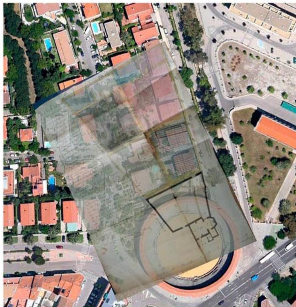
Fig. 2. Superposición del plano de proyecto de cementerio del aparejador Narciso Gallardo del año 1805 (AHM de Cáceres) a la imagen de Google Earth con la posición de la ermita de los Mártires bajo la actual Plaza de Toros.
